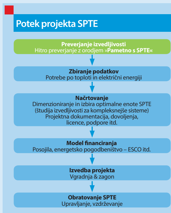
Slika 3: Diagram potrebnih korakov za uspešno vgradnjo in zagon enote SPTE
